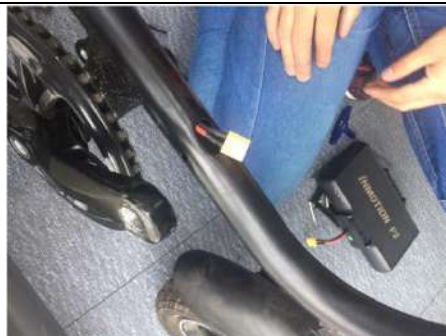
6、电池拆卸完成
