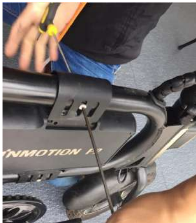
9、用六角螺丝将电池对锁内六角螺丝拧紧
