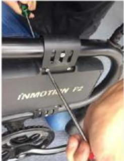
2、用两个十字螺丝刀将电池对锁十字螺丝取下
