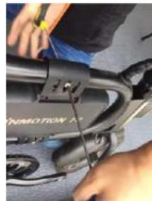
3、用六角扳手将电池对锁内六角螺丝取下
