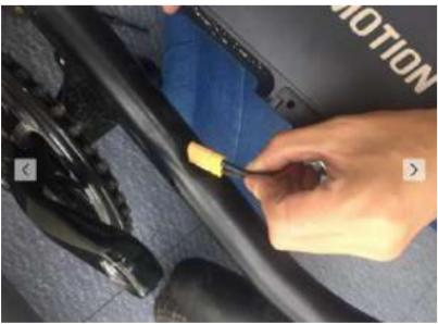
5、将电池放电端子拔出
