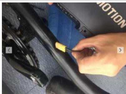
5、将电池放电端子拔出
