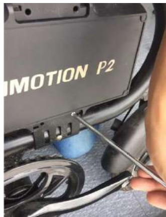
10、用十字螺丝将电池对锁十字螺丝拧紧
