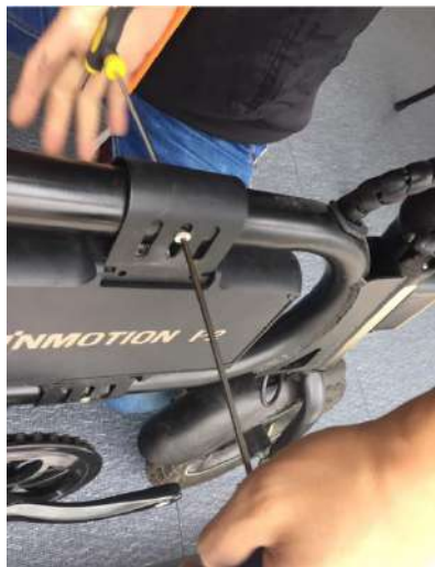
3、用六角扳手将电池对锁内六角螺丝取下
