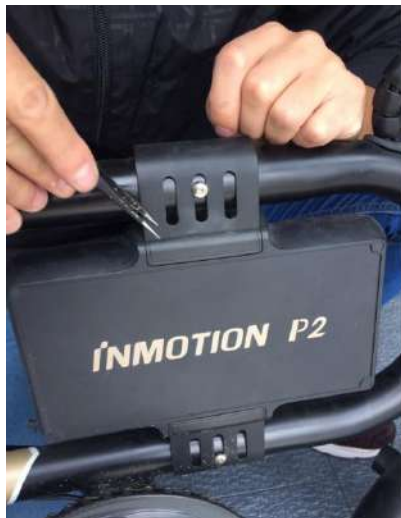
1、用镊子或刀片, 将电池固定夹装饰片取下
