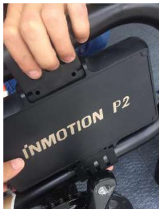
8、上下电池固定片夹住电池
