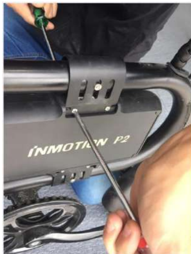
2、用两个十字螺丝刀将电池对锁十字螺丝取下
