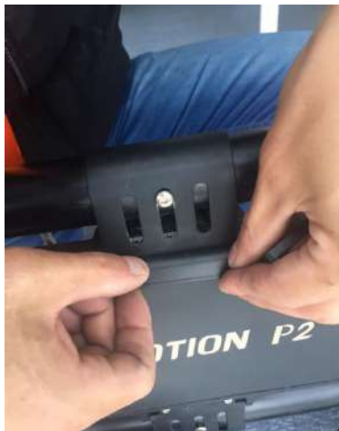
11、将电池固定片装回原位
